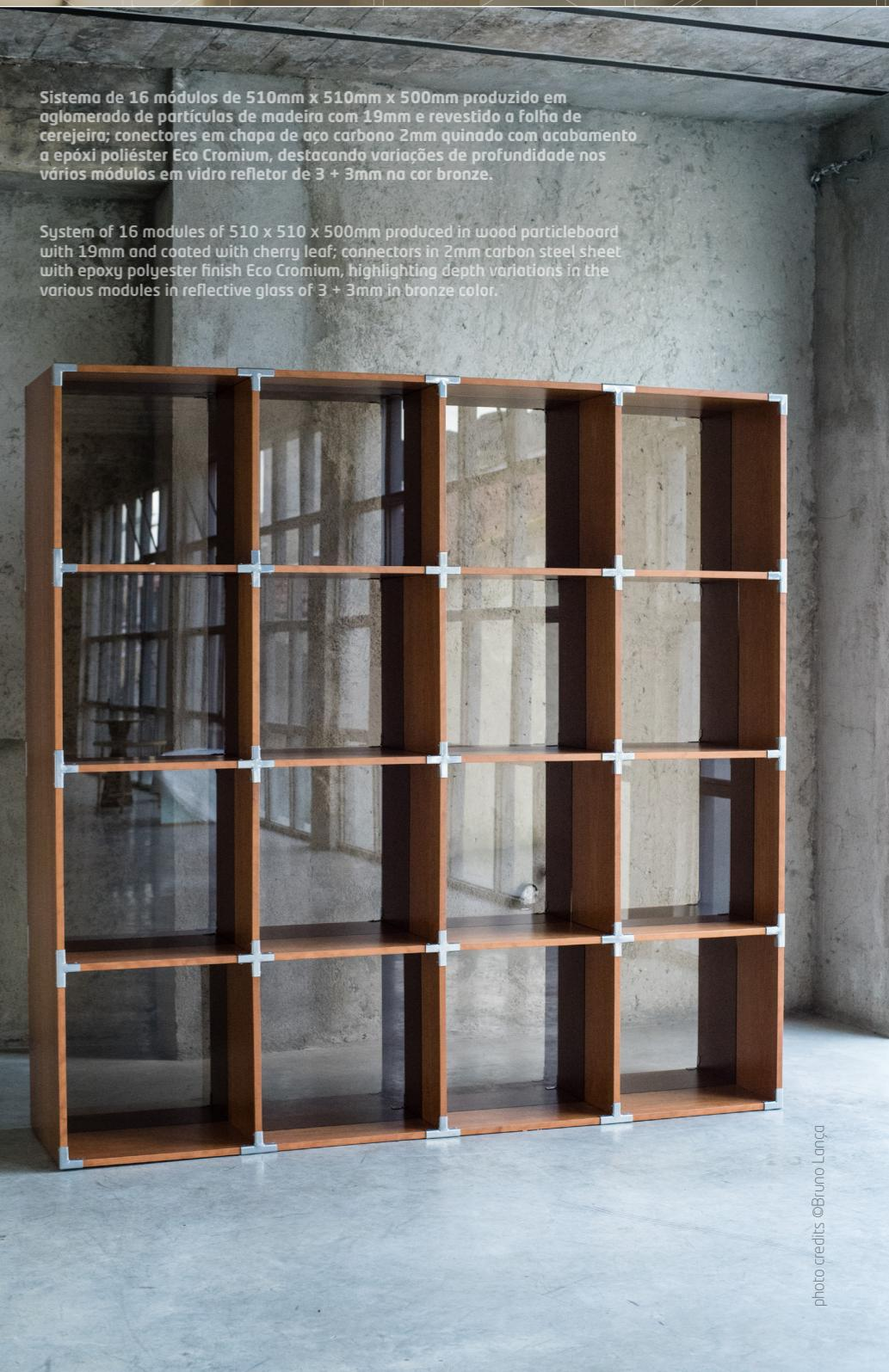
Sistema de 16 módulos de 510mm x 510mm x 500mm produzido em aglomerado de partículas de madeira com 19mm e revestido a folha de cerejeira; conectores em chapa de aço carbono 2mm quinado com acabamento a epóxi poliéster Eco Cromium, destacando variações de profundidade nos vários módulos em vidro refletor de 3 + 3mm na cor bronze.
